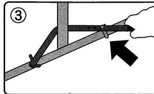
③ 「ストッパーピン」が横パイプを越えるまで手前に引いたら「パイプひきよせくん」を下にさげ、「ストッパーピン」を横パイプに引っ掛けます。
