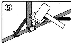
⑤ パイプ部品のクサビを仮止めしましたら、「ハンドル」をはなしてください。ハンマーでクサビを打ち込んで、作業は完了します。
