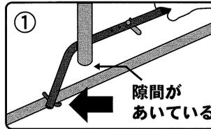
① ビニールハウスの中側から「パイプひきよせくん」を使います。「パイプひきよせくん」をアーチパイプの背(裏側)から廻し込み、「横パイプフック」を横パイプに引っ掛けます。
