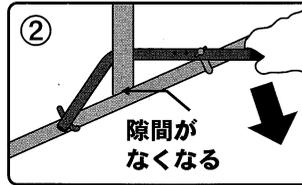
② 「アーチパイプカーブ」をアーチパイプの背(裏側)にあてて手前に引きます。その際、「パイプひきよせくん」を斜めに傾けて隣りのアーチパイプにぶつからないようにします。
